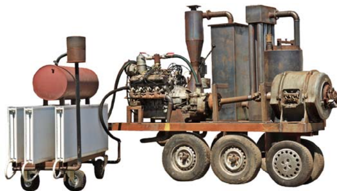
3 pav. Šiaudų dujofikavimo eksperimentinė įranga (2)
