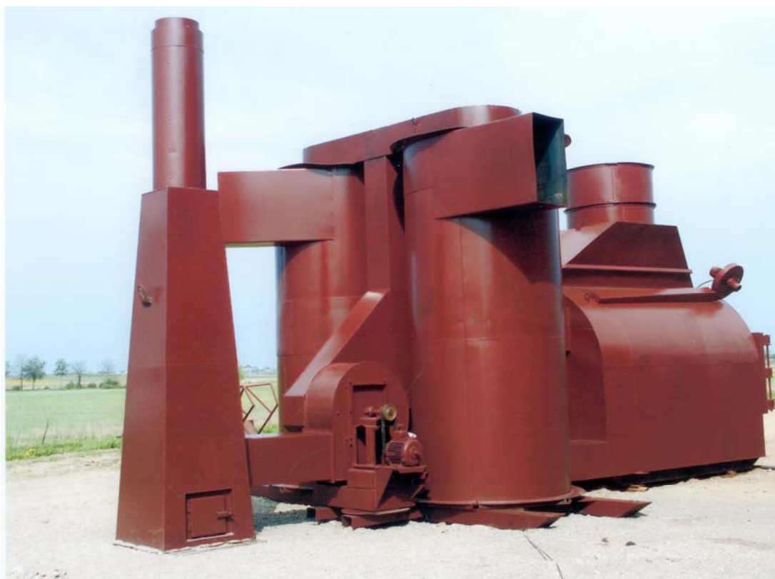
1 pav. Mokslinėje – gamybinėje įmonėje UAB „Slengiai“ sukurtas šiaudų ritiniais kūrenamas katilas
